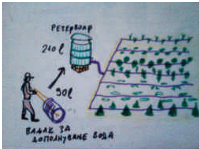
Сл. 80: Систем за наводнување со гравитационен пад
