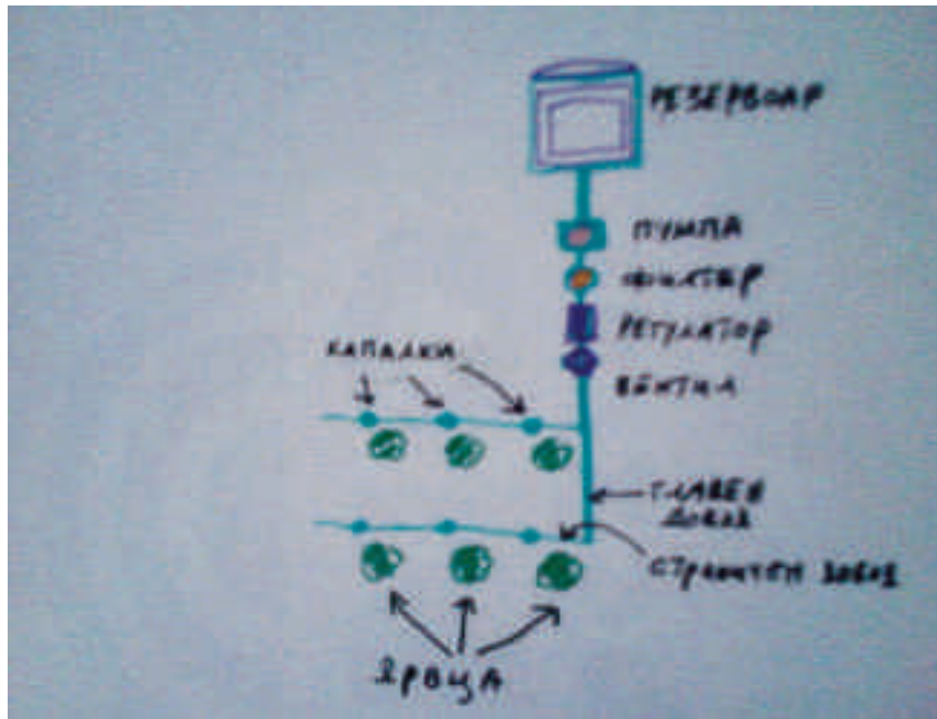
Сл. 79: Систем со резервоар, пумпа и регулатор за притисок
