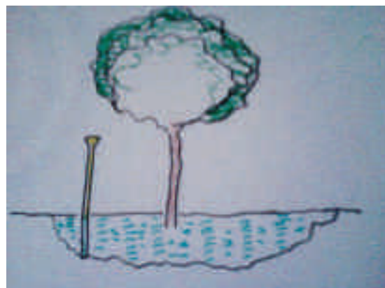
Сл. 409: Набивање на метална цевка во кореновата зона
